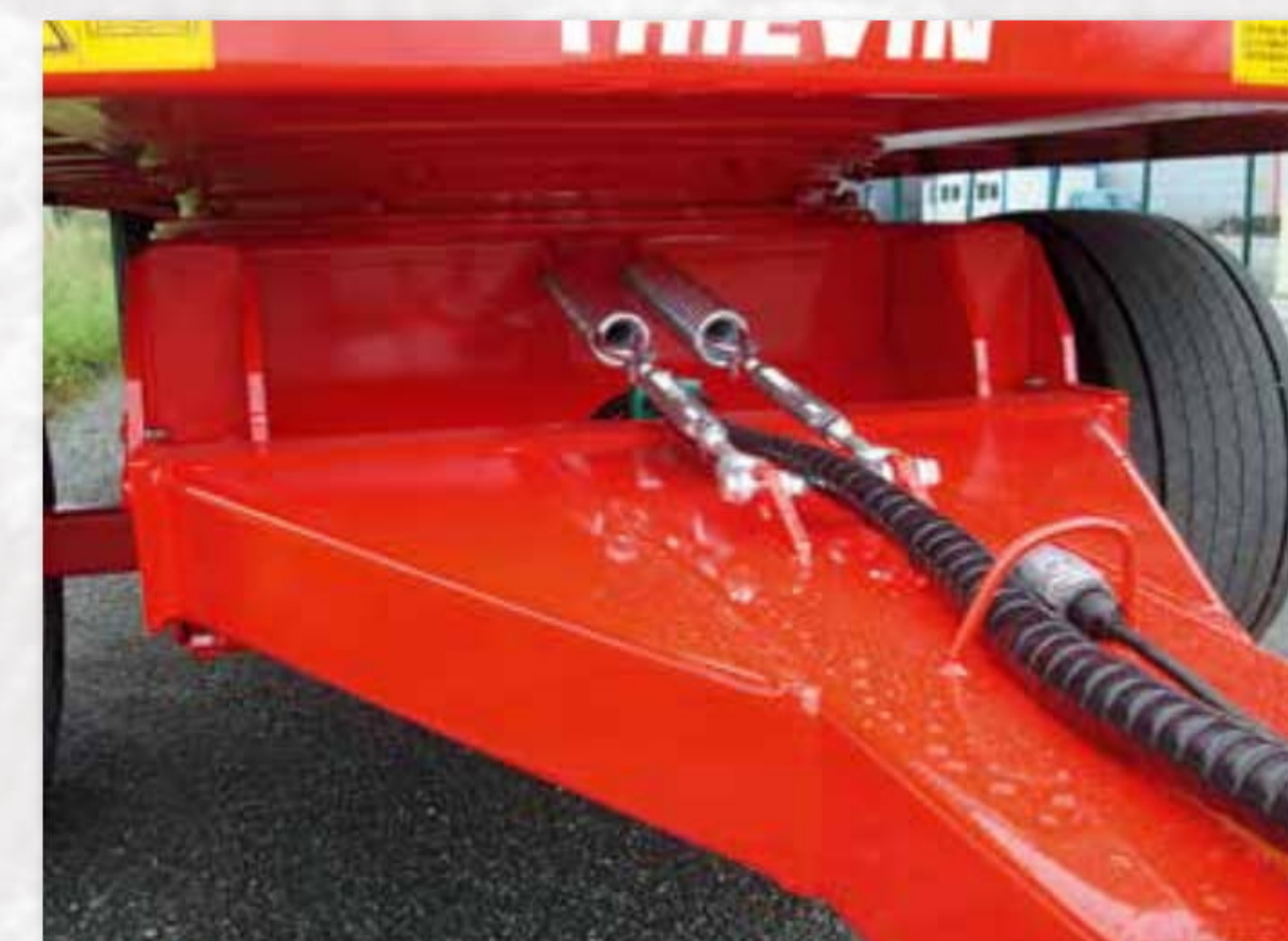
Flèche maintenue par deux ressorts réglables Arrow held by two adjustable springs
