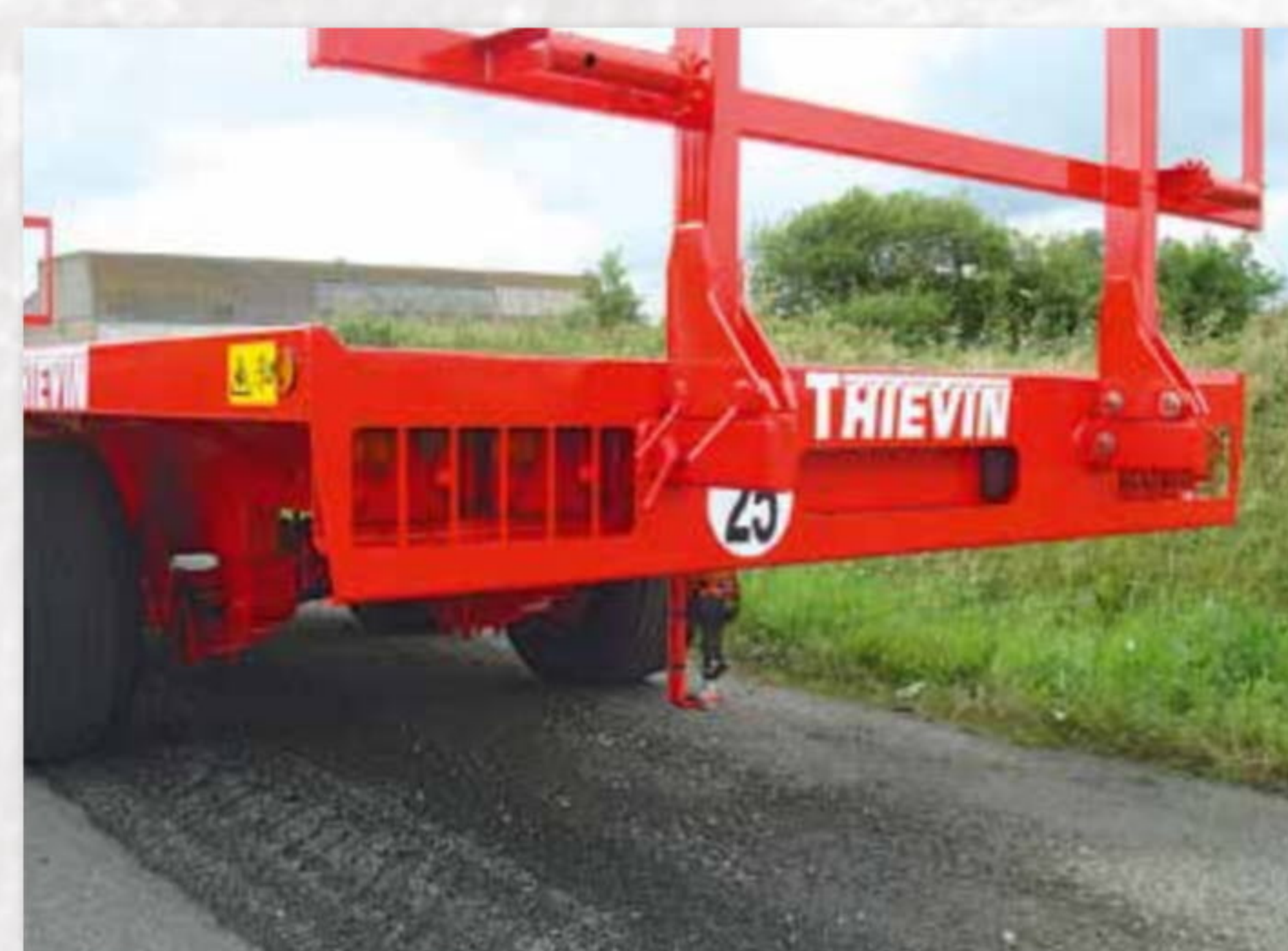
Plaque éclairée et protégée et feux intégrés Informed and protected and integrated plate lights
